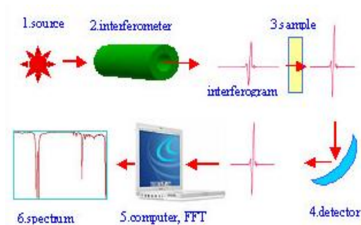
ภาพที่ 2.16 หลักการทำงานของเครื่อง FT-IR spectrometer
