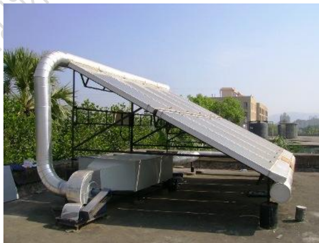
รูปที่ 2.10 แสดงเครื่องอบแห้งแบบรับพลังงานแสงอาทิตย์ทางอ้อมและใช้พัดดูดอากาศ (ทณรงค์ดี วัฒนา 2011)
