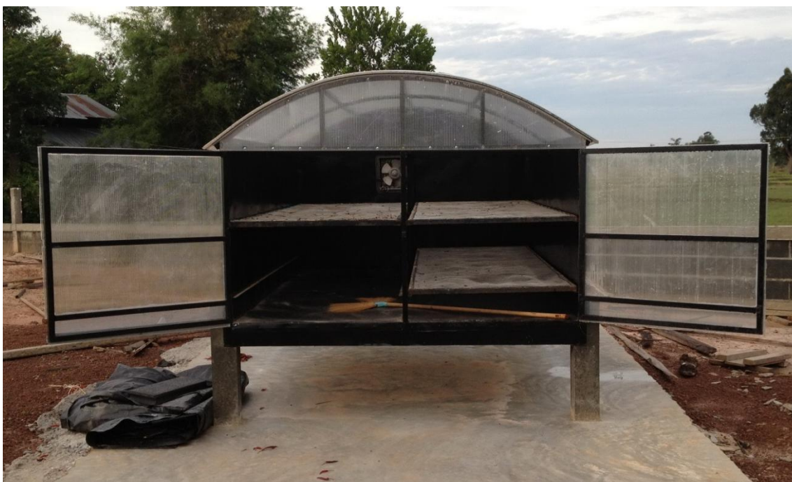
รูปที่ 3. 4 แสดงตะแกรงที่ใช้วางวัสดุที่ใช้ในการอบแห้ง
